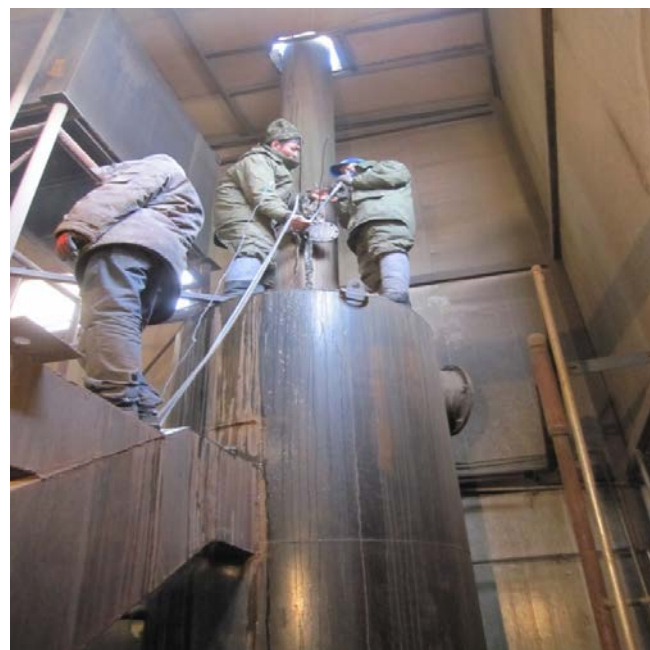
Шороо тоос бужигнасан УХЗ-ны байгууламж дахь утааны хийн хэмжилт
