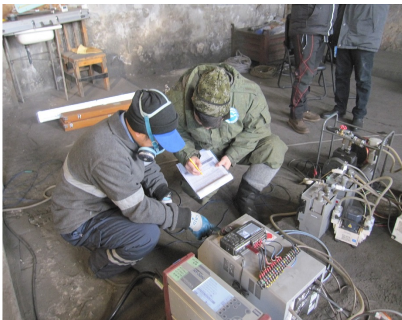
Шороо тоос бужигнасан УХЗ-ны байгууламж дахь утааны хийн хэмжилт
